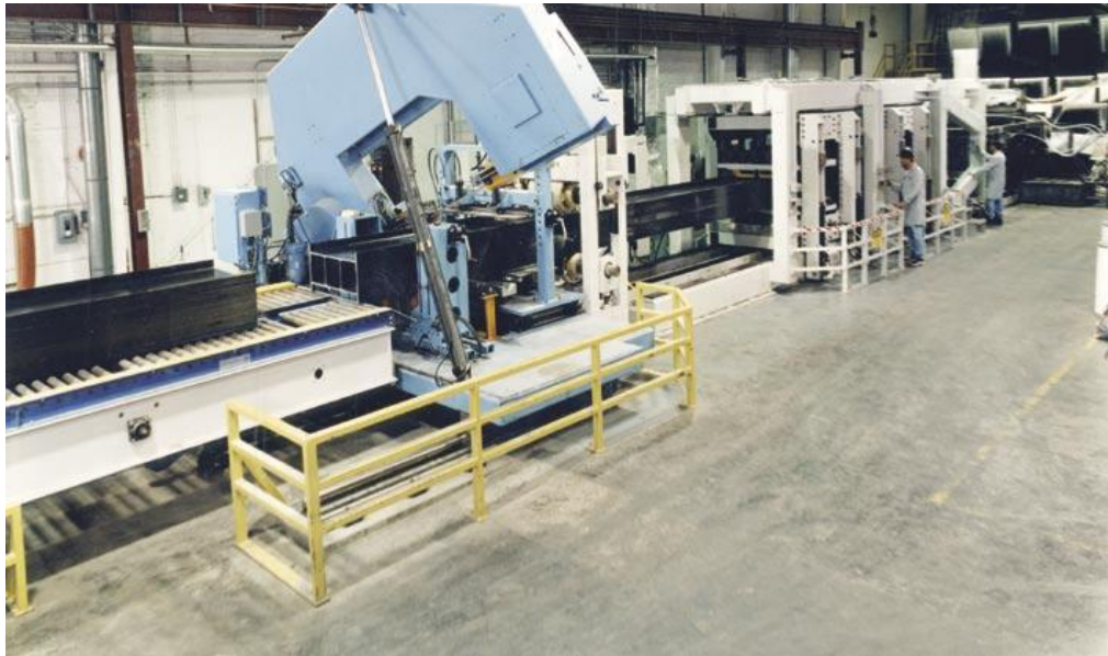
Hình 1.3: máy pultrusion dùng để chế tạo Thanh dầm.
