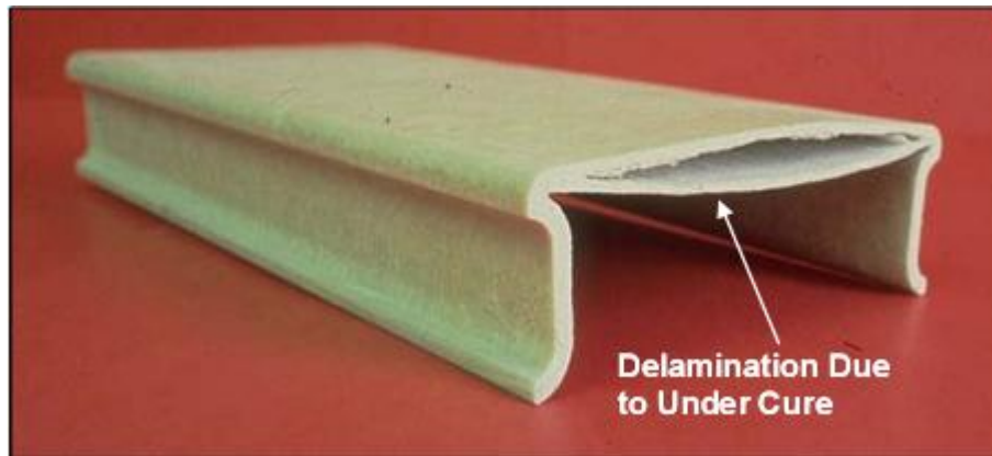
Hình: sự tách lớp do kéo với tốc độ quá cao
