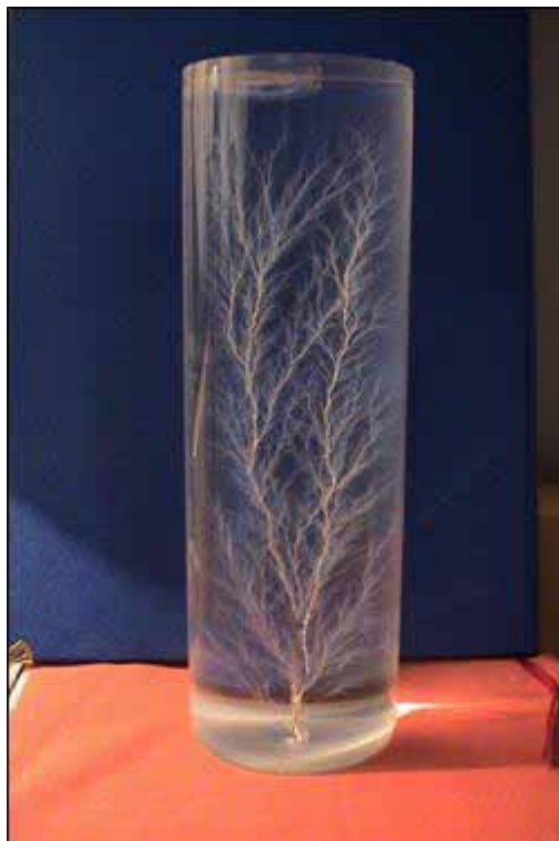
Hình 6.5 Ảnh chụp vết phóng điện trong PMMA sau khi chiếu electron từ máy gia tốc Microtron MT-17 của Viện Vật lý Hà Nội
